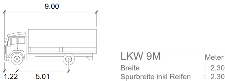
Abb. 3: Verwendete Lastwagengeometrie für Schleppkurven
